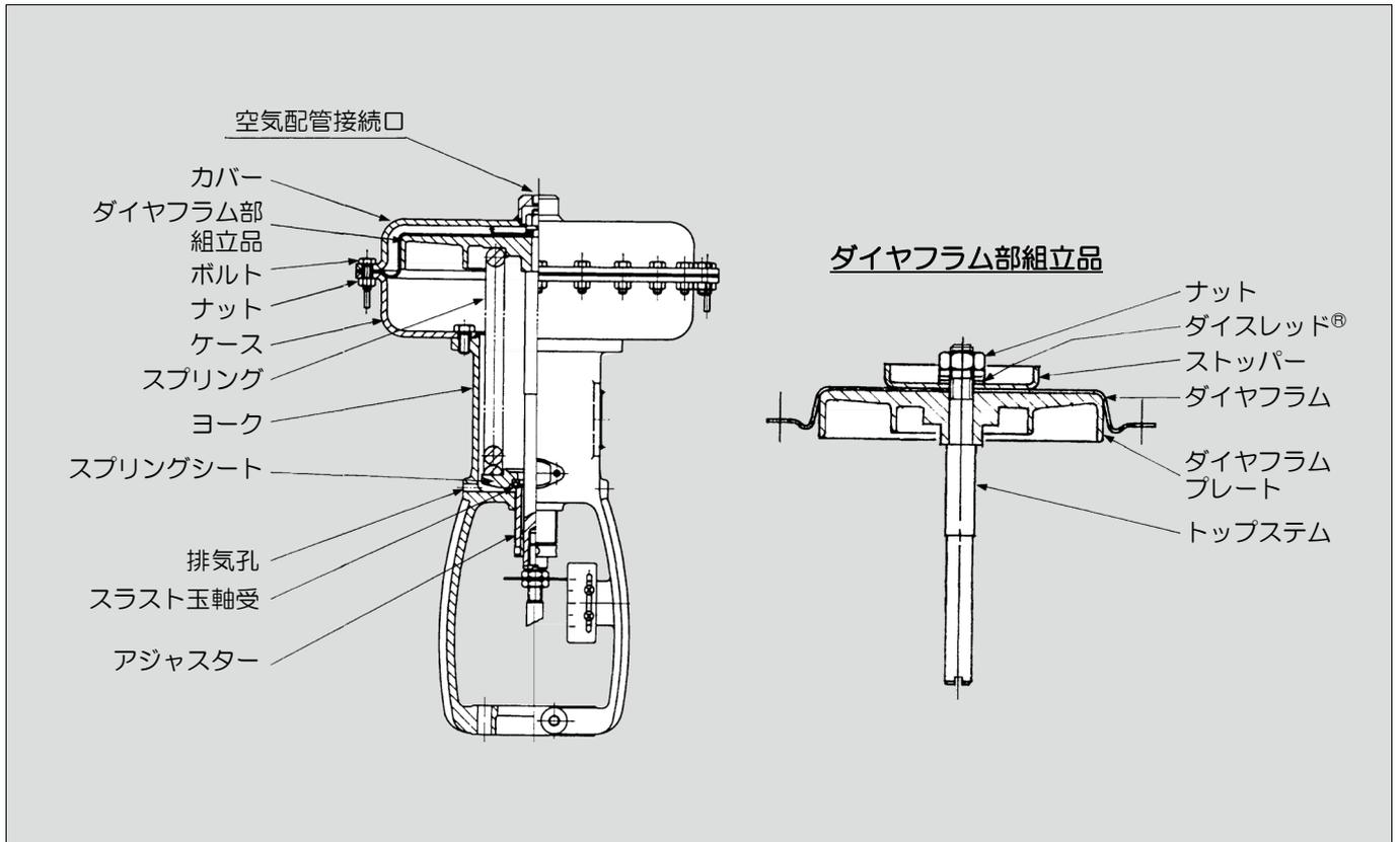
図 5-11 2800形 駆動部サイズ 500, 650 逆作動駆動部
