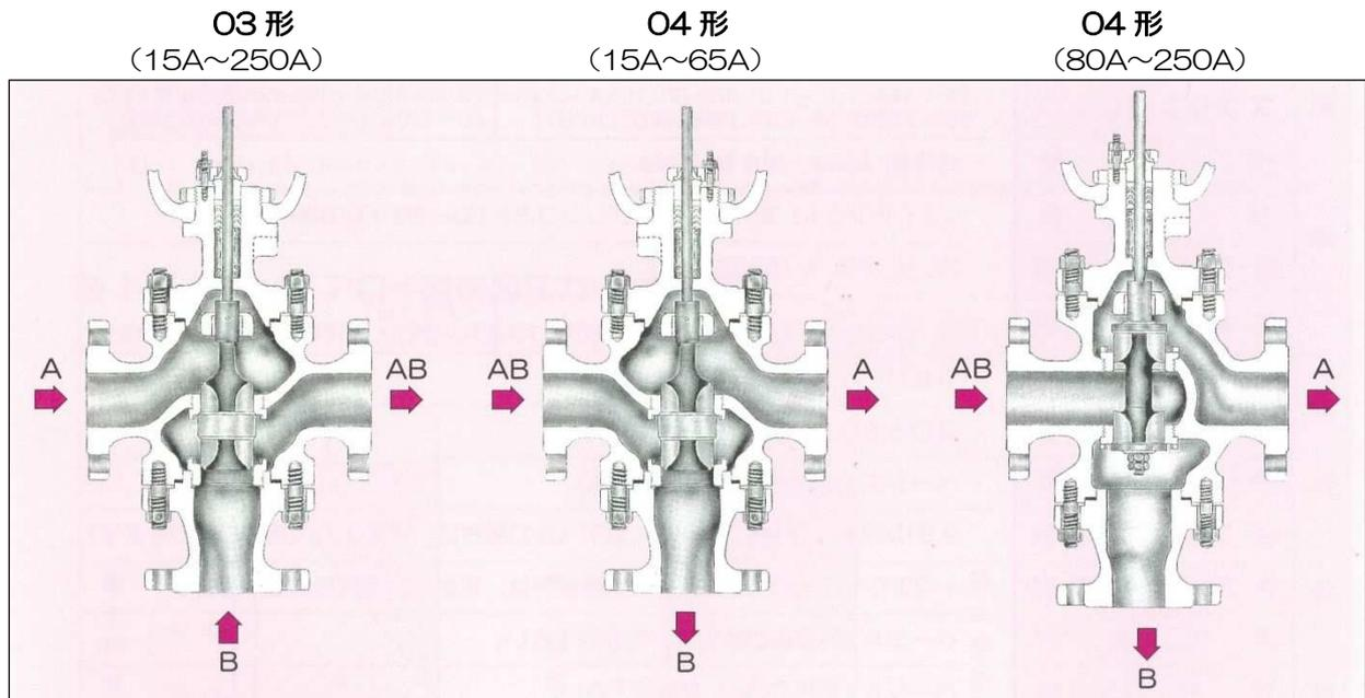
【注】本図はプレーンボンネット形構造を示します。
