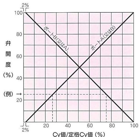
【例】 区分 D1-L (P4 参照) 分流用の場合、全トラベルの 1/4 開いたときに上流 (AB) の流量の約 74% が下流 B 側に流れ、残りの約 26% がもう一方の下流 A 側に流れます。更にトラベルが大きくなると B 側の流量は減り、A 側が増えます。
